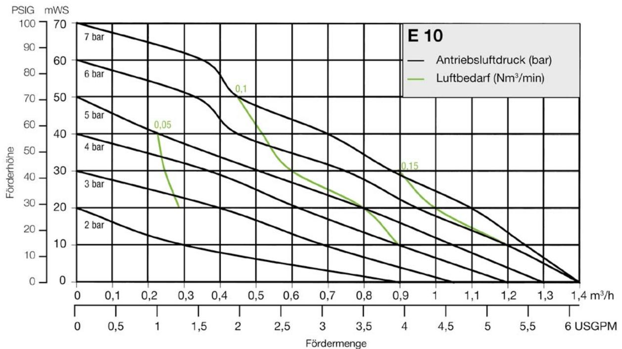
Leistungsdaten in Anlehnung an DIN EN ISO 9906. Die Daten beziehen sich auf Wasser bei 20 °C, unter Verwendung verschiedener Pumpenvarianten (z. B. Kugelventilversionen, Dämpfervorbereitung usw.), eines Kompressors Atlas Copco VSG30 und kalibrierter Messmittel.
