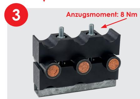
Muttern mit einem geeigneten Drehmomentschlüssel nur bis zum angegebenen Anzugsmoment wechselseitig anziehen. Keine selbstsichernden/-hemmenden Muttern verwenden, ein definiertes Anzugsmoment ist sonst nicht möglich.
